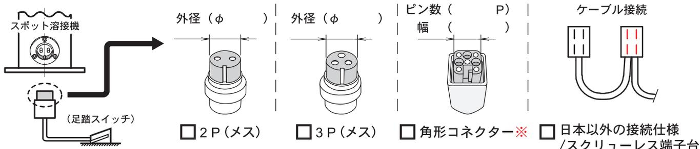
※角形コネクターを選択した場合、起動信号確認のため、写真と電気図面を添付してください。
