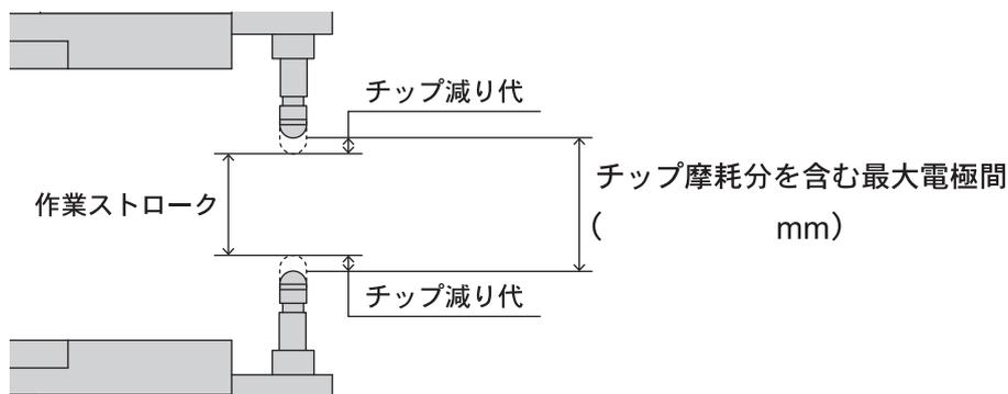
8) 溶接機加圧シリンダーの全ストローク長さ
